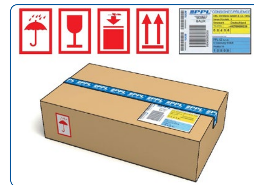
Manipulační značky nenahrazují kvalitní obal a výplně (ČSN EN ISO 780). Zásilka je označena pouze jedním štítkem PPL!
